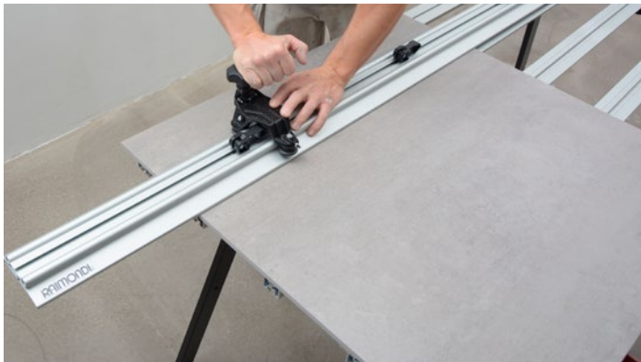
Opridsning af flise med styreskinne
