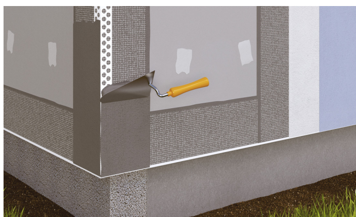
Placér hjørnelisten i den friskpåførte armeringspuds
