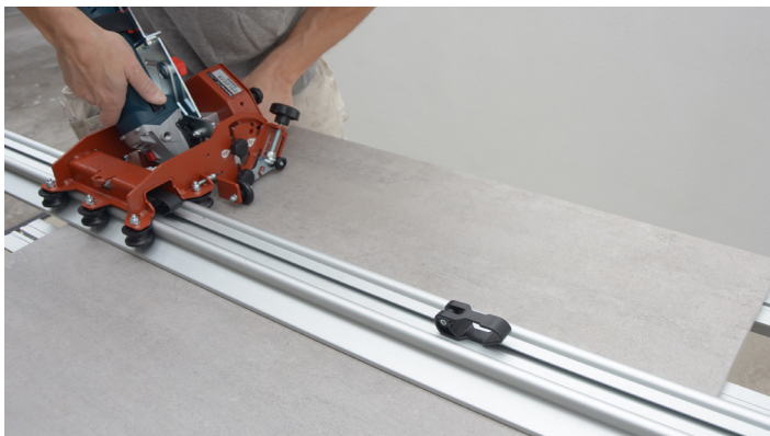
Skäring av plattor efter styreskinne
